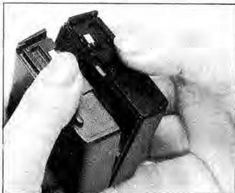
Achten Sie beim Einlegen der Batterien immer auf die richtige Polarität und wechseln Sie immer alle sechs Batterien zusammen. Der Batteriekasten oder Akkupack wird sinn gemäß in umgekehrter Reihenfolge wieder angedockt.
