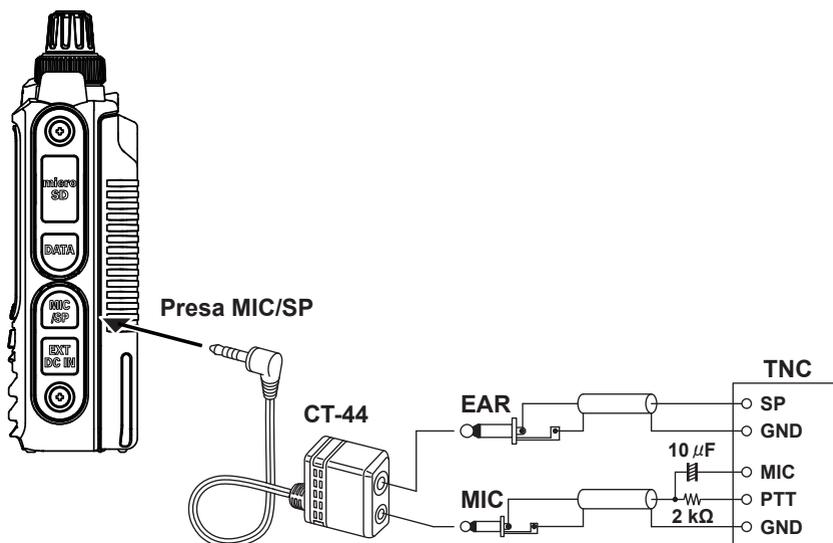
Dopo il collegamento del TNC al ricetrasmittitore, impostare il livello del segnale trasmesso al TNC regolando il volume del proprio ricetrasmittitore.
