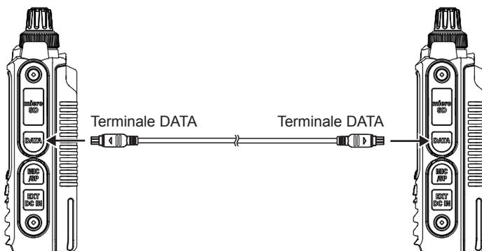
1. Disinserire l'alimentazione di entrambi i ricetrasmittitori FT3DE e collegare un cavo di clonazione opzionale (CT-168) al terminale DATA di ciascun ricetrasmittitore.
