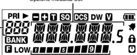
Strumento S: visualizza l'intensità del segnale ricevuto
