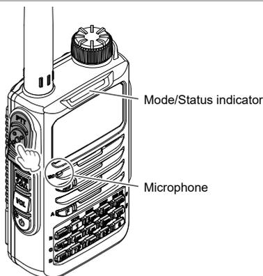
2. Отпустите переключатель PTT, чтобы вернуться в режим приема. При приеме сигнала индикатор MODE/STATUS загорается в соответствии с режимом приема.
