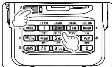
Если сканирование приостановлено на сигнале, вращение ручки DIAL приведет к немедленному возобновлению сканирования. Способ возобновления сканирования после его приостановки по сигналу может быть выбран в течении approx. 0,1 - 10 сек при использовании режима настройки [53 SCN\_STR] (стр 33).
