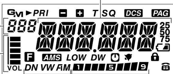
S Meter : Отображает измеренный уровень мощности сигнала
