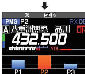
選択中のPMG 2CH で信号を受信したので、バーグラフ表示を一時停止して、受信音を出力
