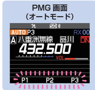
オートモードではスキャンして信号のあるチャンネルに自動で停止して信号再生します。(スキャン中はチャンネル番号が点滅します)
