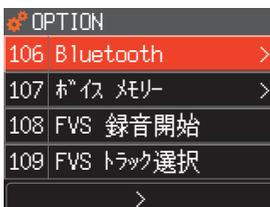
4. DIALツマミを押して【Bluetooth】を“ON”にします。設定項目が表示されます。
