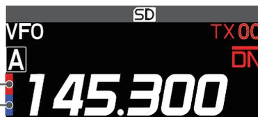
**i** デジタルモード時に自局と異なるDG-ID を含んだ信号を受信すると、緑（上側）と青（下側）が点滅します。FMモード時に自局と異なるトーン信号やDCS を含んだ信号を受信すると、緑（上下）が点滅します。
