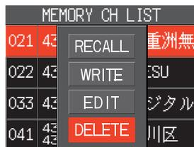
2. **DIAL**ツマミをまわして、消去するメモリーチャンネルを選択して**DIAL**ツマミを押します。
