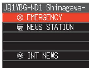
3. **PTT** スイッチを押すと、ビーブ音が鳴って“**EMERGENCY Upload?**”と確認画面が表示されます。緊急の情報を送る場合は、そのまま **PTT** スイッチを押し続けると、ビーブ音が3回鳴った後に約5秒間“**EMERGENCY UPLOADING**”が表示され、その後カウントダウンを開始しますのでマイクに向かってメッセージを話します。録音可能な時間は最大1分間です。1分を越えた部分の音声は保存されません。
