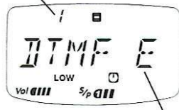
Primer tono DTMF que se envía (en este caso, representa un asterisco)
