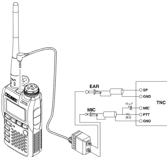
*Quand vous utilisez le mode Packet, enlever l'économiseur de batterie en réception, pour éviter la collision entre le début d'un cycle de "sommeil" et le début de l'arrivée d'une trame packet, empêchant votre TNC de recevoir la trame de donnée complète. Voir page 93 Pour plus de détails pour l'initialisation de l'économiseur de batterie.*
