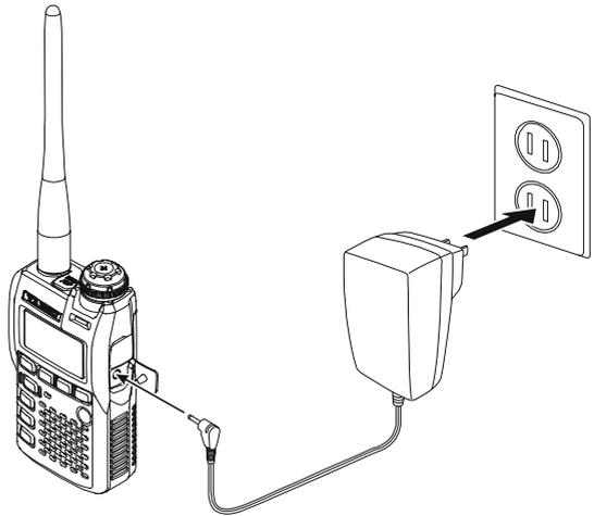
L'afficheur indique "**CHGING**" et l'indicateur **TX/BUSY** est rouge, tant que les batteries sont en charge. Le Smètre dévie en relation avec l'état de charge.
